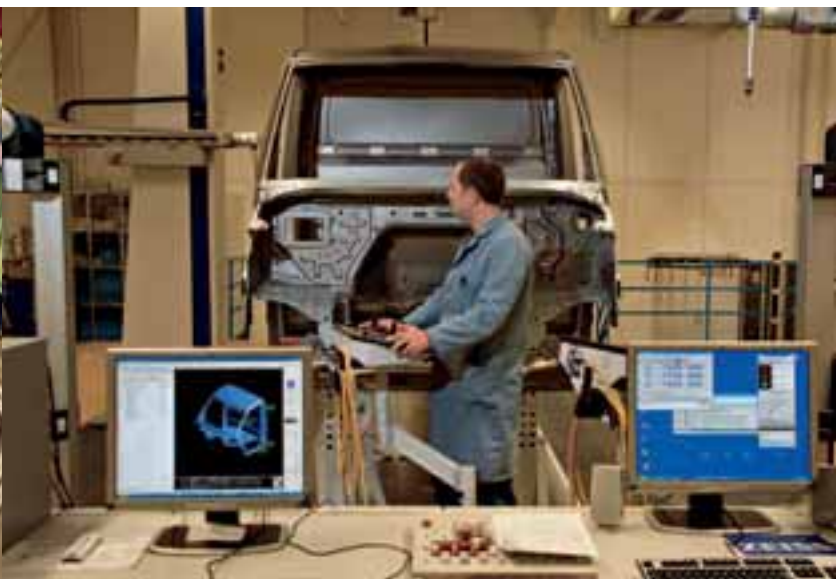
Mit modernster 3D-Messtechnik wird der Fertigungsprozess permanent überwacht.
