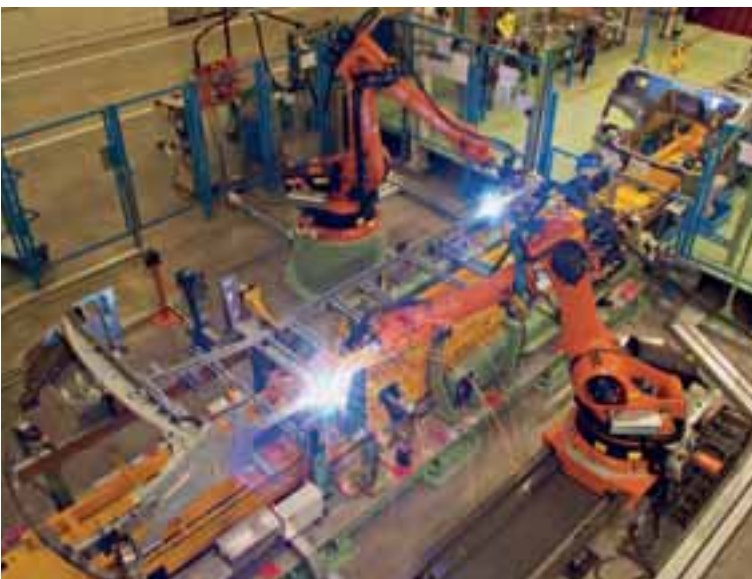
Im Sprinter-Rohbau übernehmen weitgehend Roboter die Fertigung.
